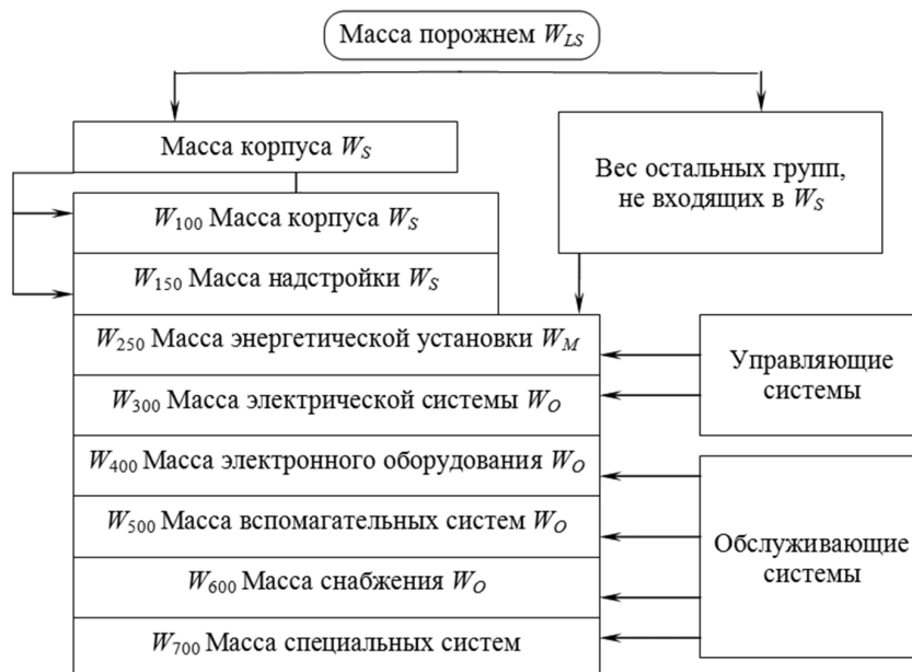
Рис. 1. Схема разбивки массы порожнем на составляющие
